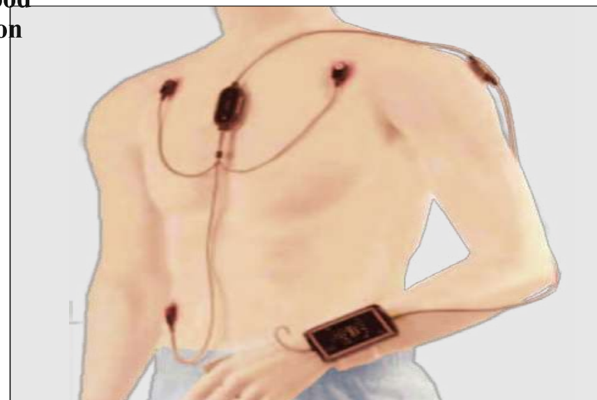
Figura 1. Equipo de monitorización de la presión arterial que no requiere manguitos de presión.
